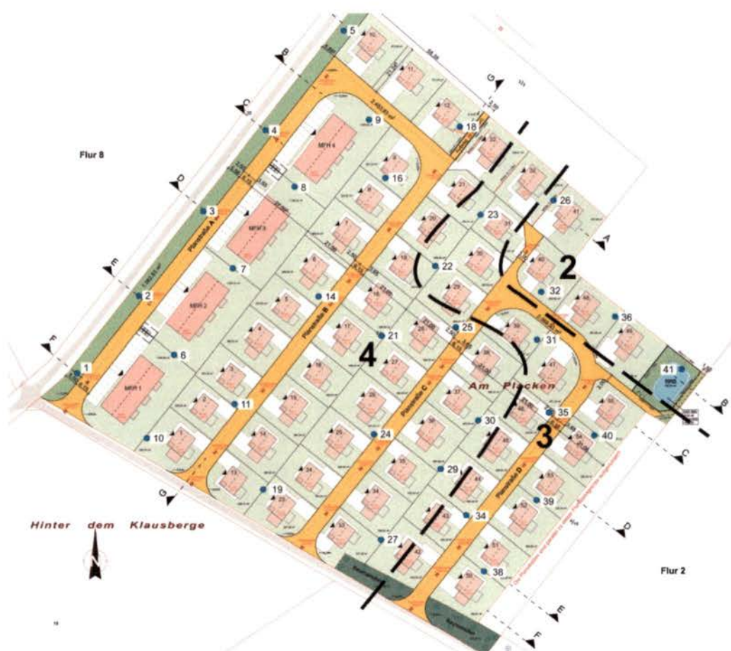
Abbildung 5: Homogenbereiche unterhalb des Oberbodens
