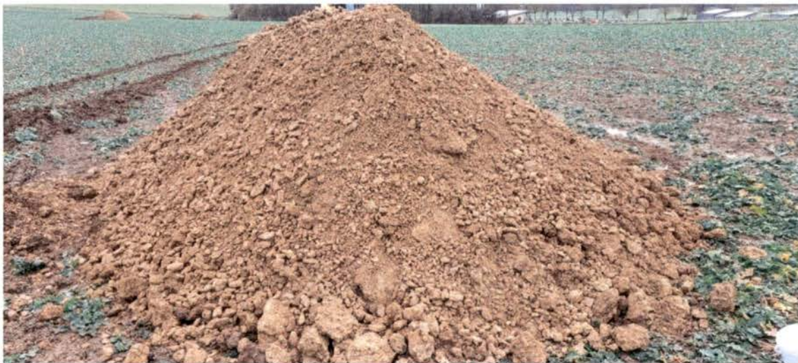
Abbildung 7: Haufwerk au SG 19 (Kulmgrauwacke: zersetzt, entfestigt)
